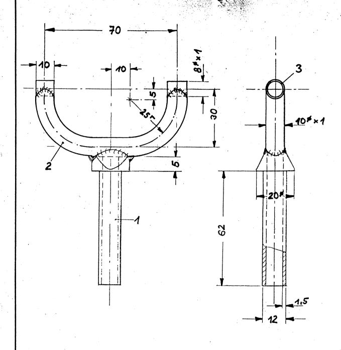
Im WIG-Verfahren mit Zusatzwerkstoff 1.7734.2 geschweiht. Grundiert mit Wash-Primer 42002 + Härter 40018. Decklackierung mit Nitro-Lack grau RAL 7003.
